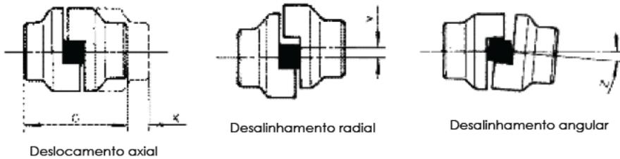
Um alinhamento correto do acoplamento aumenta a vida do elemento elástico. Para rotações próximas de  $n_{m\acute{a}x}$  recomendamos usinagem dos cubos do acoplamento.
